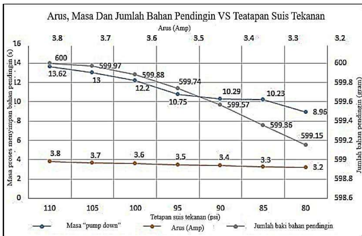
Rajah 3: Ringkuman data dari hasil semasa, perubahan masa, baki jumlah bahan pendingin dan tetapan suis tekanan
