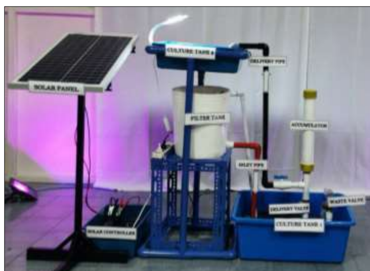
Rajah 2: Pemasangan Sistem G3 Hybrid RAS
