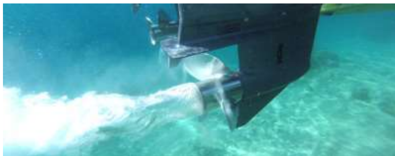
Rajah 4: Pelepasan gas ekzos enjin sangkut di dalam air
